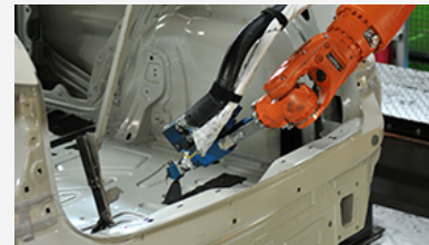
Auftrag der spritzbaren Dämpfung
