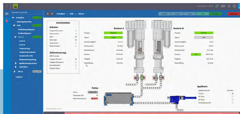
Visualisierung der Anlage mit 2 Dosieren (gleichzeitiges leeren und befüllen), (Rot = Störung bzw. Grenzwertüberschreitung (Konfiguration mit Farbhinterlegung))
